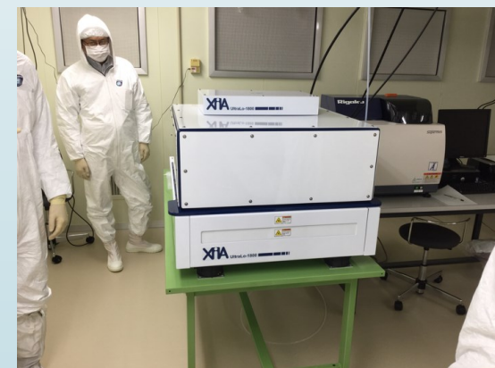
アルファ線検出器による表面測定と内部の鉛測定
